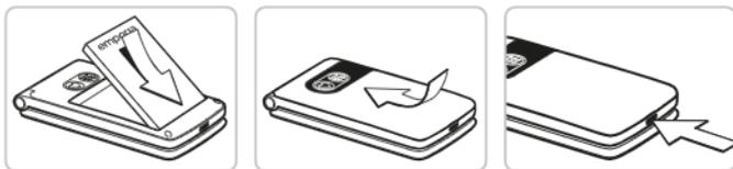
1. Insérez la batterie de sorte que les contacts de la batterie touchent les contacts dorés du téléphone portable.
