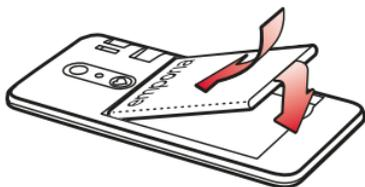
Placez la batterie de sorte que la partie dorée de la batterie touche celle du téléphone. Appuyez sur le couvercle de la batterie jusqu'à son enclenchement.
