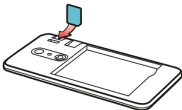
L'emplacement pour la carte SIM se trouve à droite, au dessus du compartiment de la batterie et du support de la carte mémoire. Insérez la carte avec la partie dorée vers le bas.
